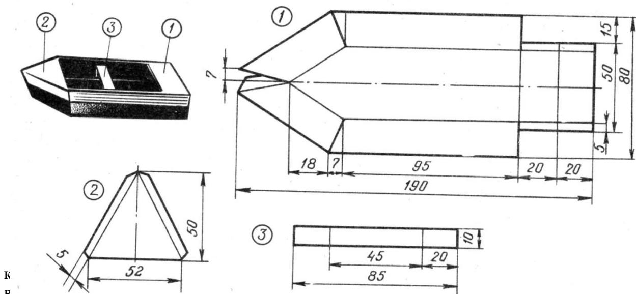
либо другим приспособлением, так же по линейке, для того, что бы картон сгибался точно по намеченным линиям сгиба. Все части выкройки загибаются в одну сторону (вверх или вниз) и затем корпус склеивается. В начале склеиваются борта между собой в носовой части, а затем в кормовой. Все приклейки должны располагаться внутри корпуса.
